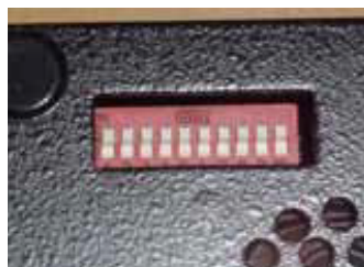
子機裏ディップスイッチの設定(標準全部ON)
